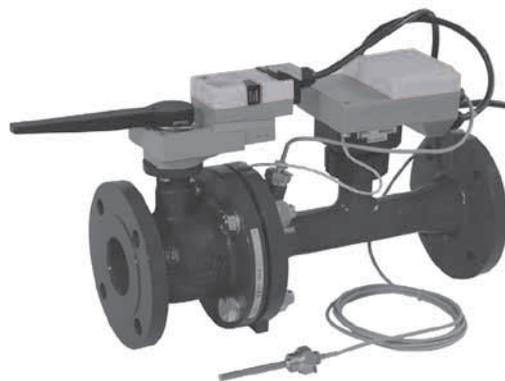
Новый клапан Белимо **Energy Valve** является следующим этапом развития клапана EPIV – клапана с расходом, не зависящим от перепада давления на клапане, и оборудованным электронным датчиком расхода. Как и EPIV, клапан Energy Valve может выполнять четыре функции – измерение расхода, управление с помощью электропривода, динамическую балансировку системы и запорную функцию.
