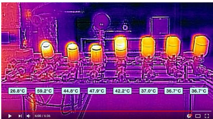
**В силу принципа действия термоэлектрических приводов (последовательные циклы нагрева), их потребляемая мощность значительно выше, чем у электропривода Белимо.** Так, согласно видео, температура поверхности термоэлектроприводов составляет от 35 до 56 °С, в то время как температура поверхности электропривода Белимо равна температуре окружающей среды и составляет 26 °С.
